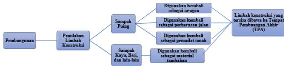
Gambar 3 Proses Pengolahan Limbah Konstruksi di Kawasan PNJ
