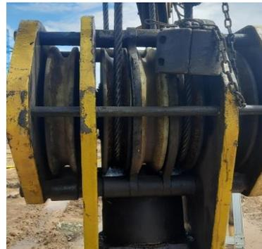
Gambar 2 Sistem pulley actual
