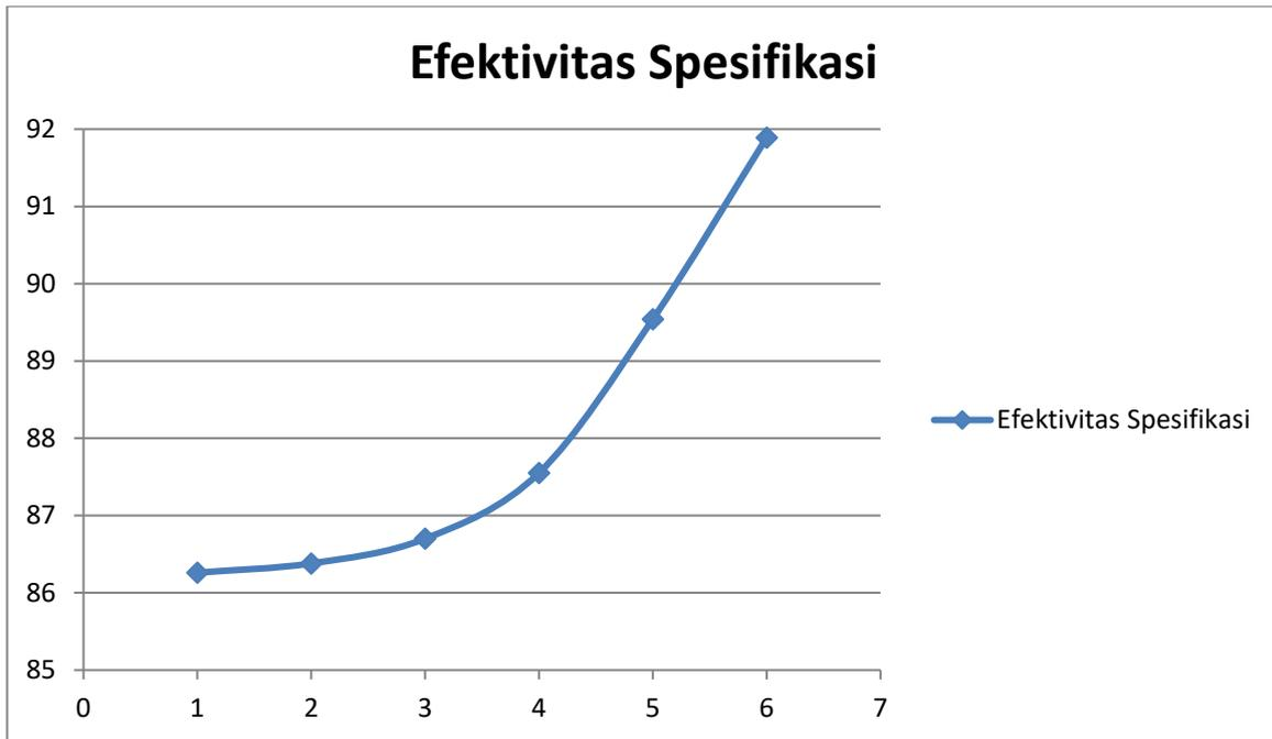
Gambar 3 Grafik Efektivitas Kondensor Kondisi Spesifikasi Dengan Rekayasa
