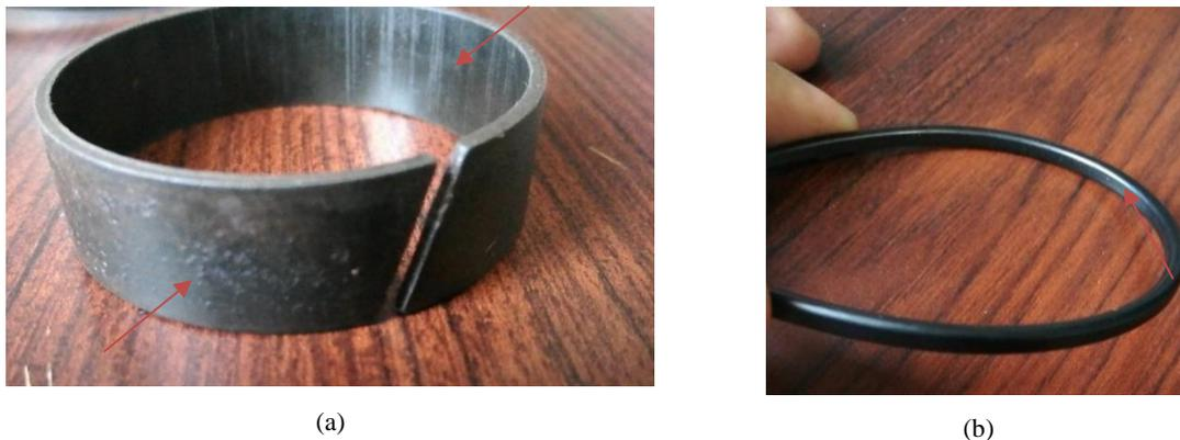
Gambar 6. Kondisi *ring wear* pada gambar (a). Gambar (b) Kondisi *seal o-ring*
