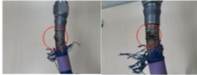
Gambar 3 . Terjadi damage berupa hole pada permukaan inner tube
