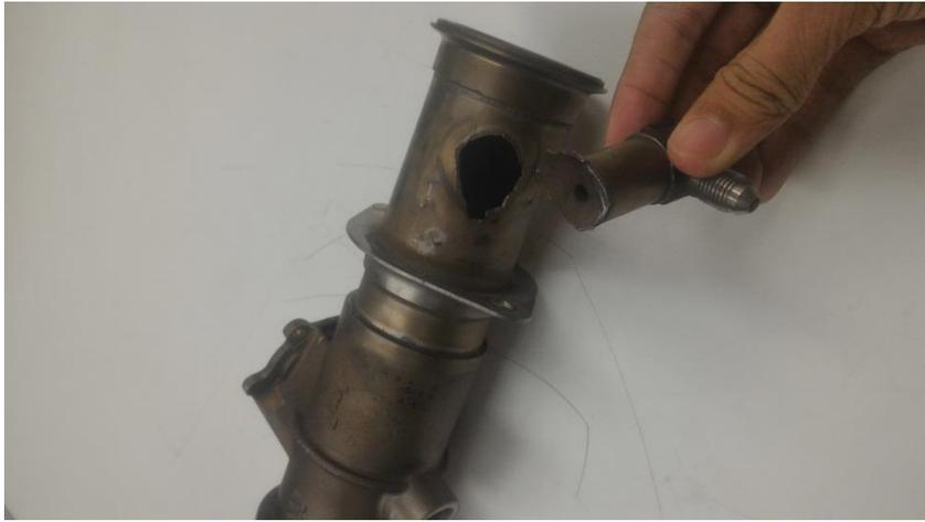
Gambar 4. Housing crack karena pergantian komponen yang tidak teratur
