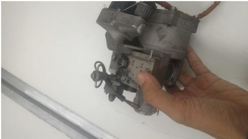
Gambar 5. Shut off Valve (SOV) yang rusak karena Guide set Poppet sehingga harus di adjusting manual
