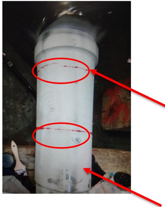
Gambar 1. Keretakan pada screw
