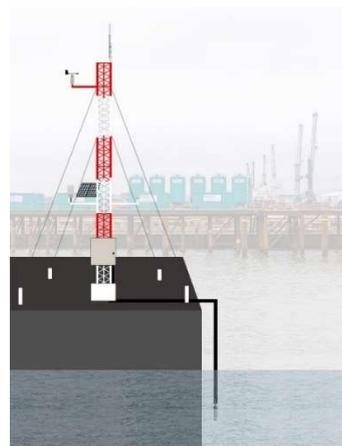
Gambar 6. Skematik Pemasangan Sensor *Water level*
